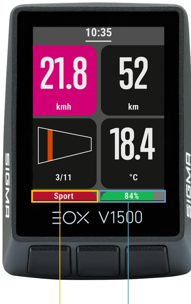
Im unteren Bereich befindet sich die Anzeige für den gewählten **Assist Modus** und den **Ladestand** der E-Bike Batterie.
