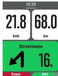
Der EOX® VIEW 1500 CAN springt automatisch auf eine neue Seite mit Komoot-Navigation
