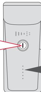
**NOTE:** If the battery capacity is less than 20 %, the red indicator LED lights up and after about 45 minutes, the red LED begins flashing, and the BUSTER 1600 goes out completely shortly thereafter. / **HINWEIS:** Bei weniger als 20 % Akku-Kapazität leuchtet die rote Indikator-LED auf und nach etwa 45 Min. blinkt die rote LED. In Kürze geht die BUSTER 1600 komplett aus.
